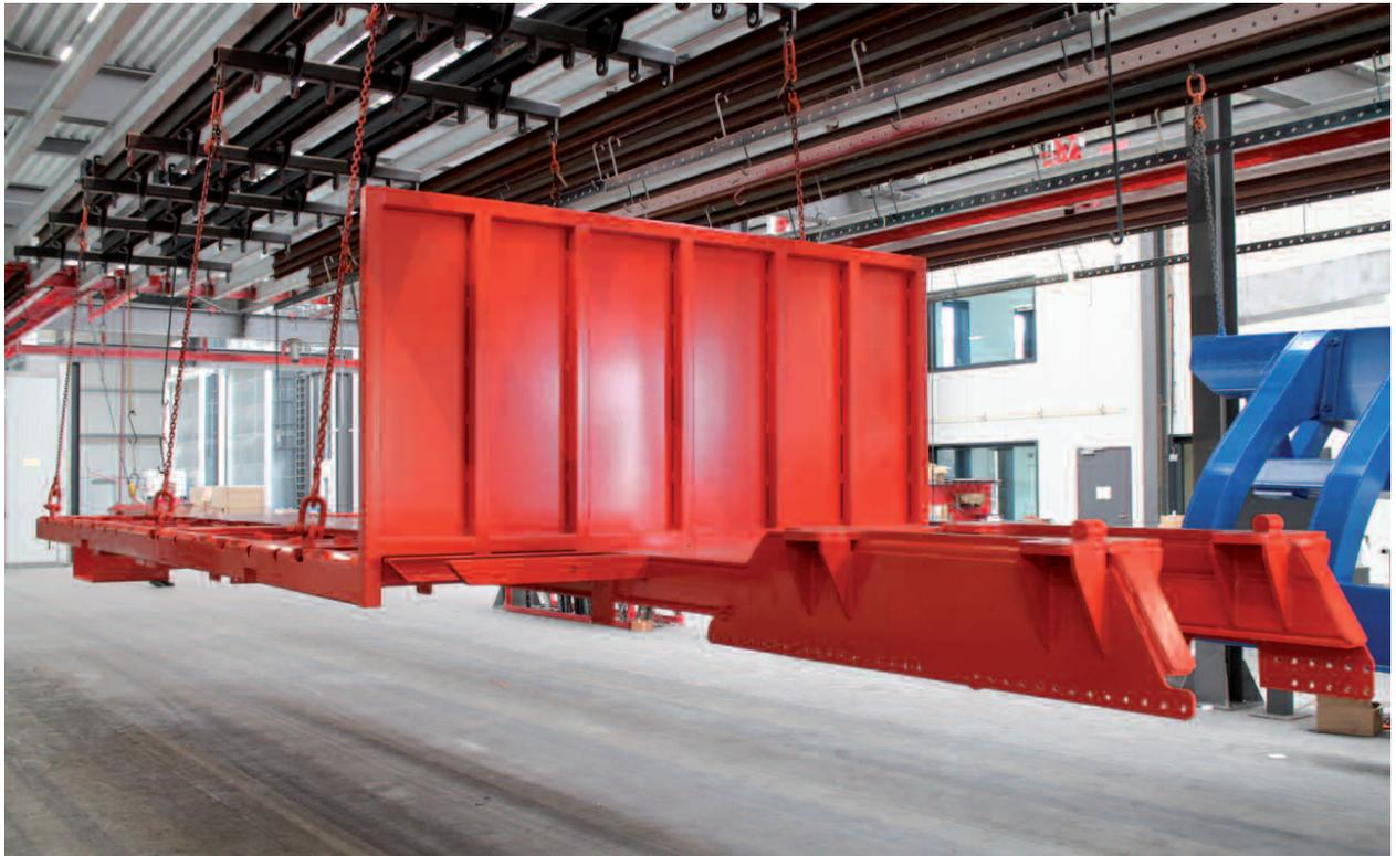
Großbauteile wie LKW-Pritschenaufbauten können dank „Park and Drive“-System mühelos von einer zur anderen Station bewegt werden!
