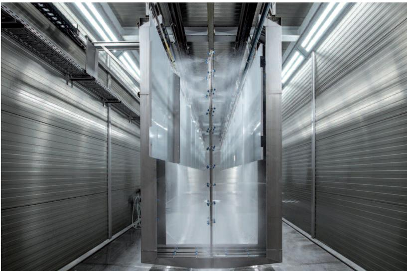
Der Waschautomat kann zwei schmale Traversen gleichzeitig vorbehandeln und verfügt über Waschtechnik für Stahl, Alu und Zink.
