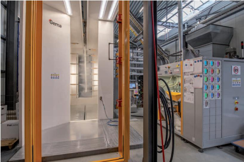
Die GEMA-Automatikkabine ist mit 14 Automatik-, 1 Handpistolen, Pulverrückgewinnung und eine automatische Objekterkennung ausgestattet.
